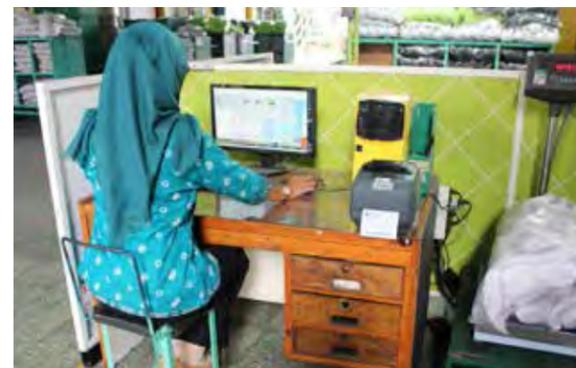
本公司 PCN 事業部的廠區全面推動廢棄物數位化管理制度 (Barcode system)，藉由電子秤連結資料庫系統，從生產線到儲放中心及最後清運處理，皆採取條碼掃描全程管控，有效提升廢棄物數據精確度。該資訊條碼記載有產線名稱、廢棄物類別、重量、危害性類別註記以及清運廠商名稱。
